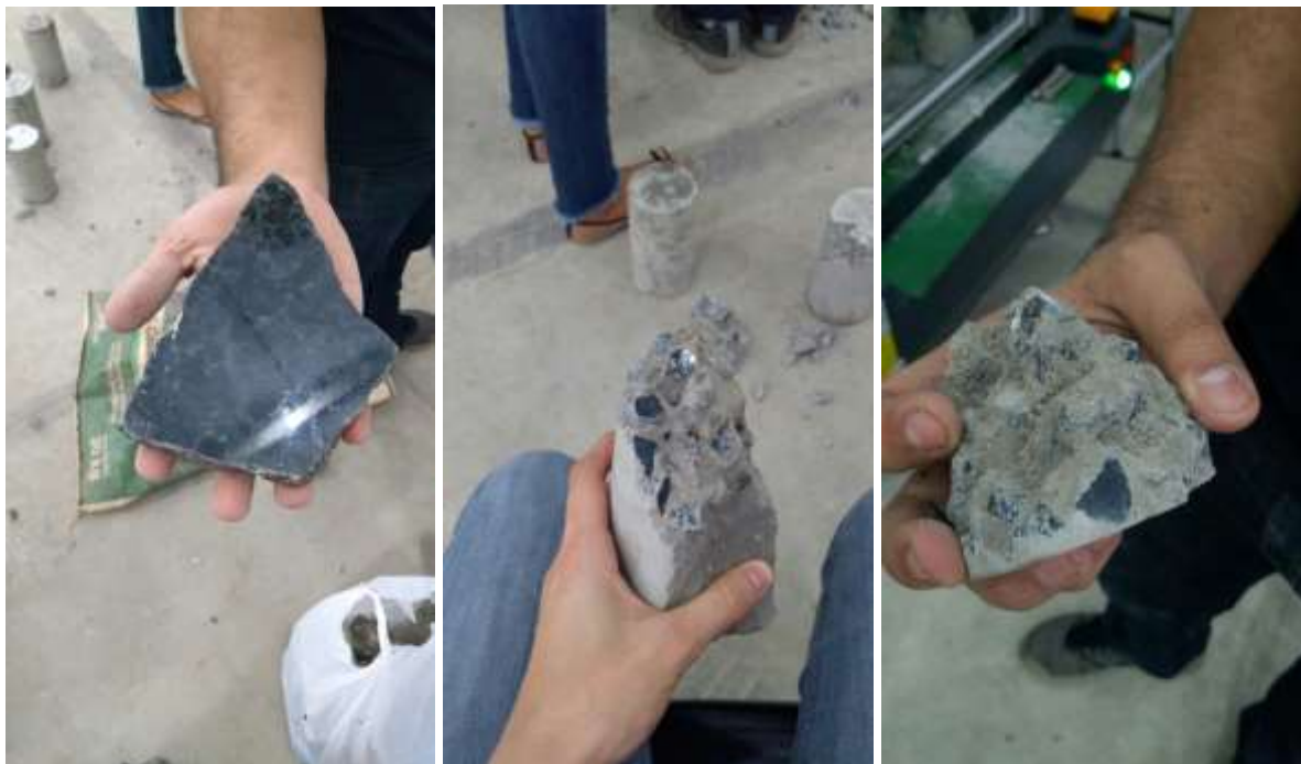
Figura 1- Corpos de prova rompidos com parte lapidada do agregado a mostra
