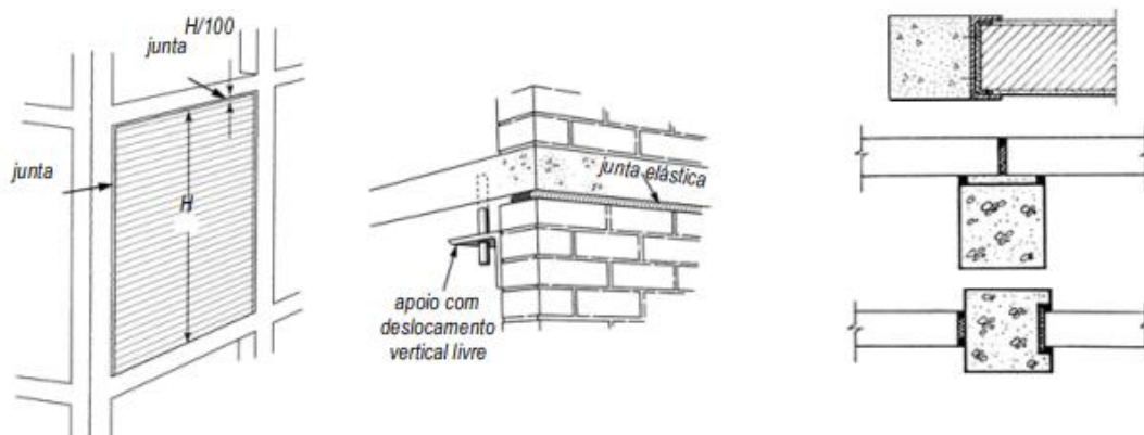
Figura 4: Juntas elásticas de dilatação
